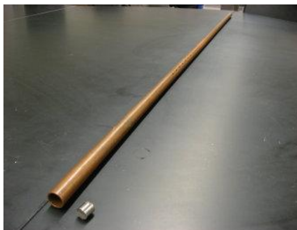
12. kísérlet: Mágnes esésének lassulása rézcsőben (Lenz-törvény demonstrálása)
