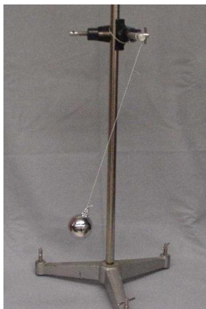
19. kísérlet: Fonálinga lengésidejének mérése gravitációs gyorsulás meghatározásához
