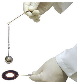
7. kísérlet: Szilárd testek (Gravesande golyó) és bimetál hőtágulása
