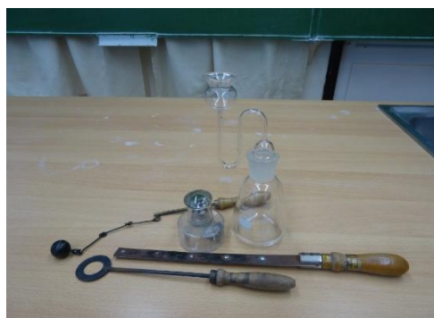
7. kísérlet: Szilárd testek (Gravesande golyó) és bimetál hőtágulása
