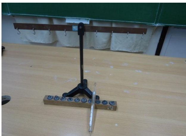
4. kísérlet: Forgatónyomaték és emelő vizsgálata mérleggel
