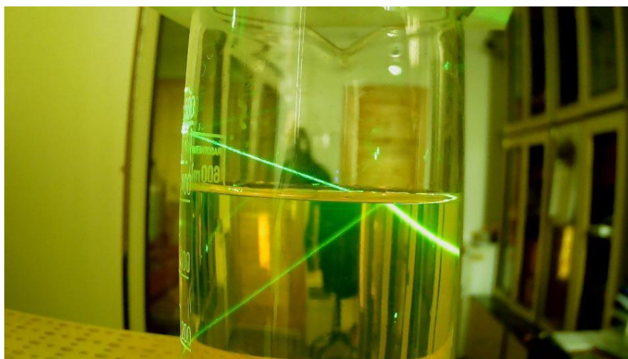
14. kísérlet: Lézersugár fénytörése és teljes visszaverődése vízben
