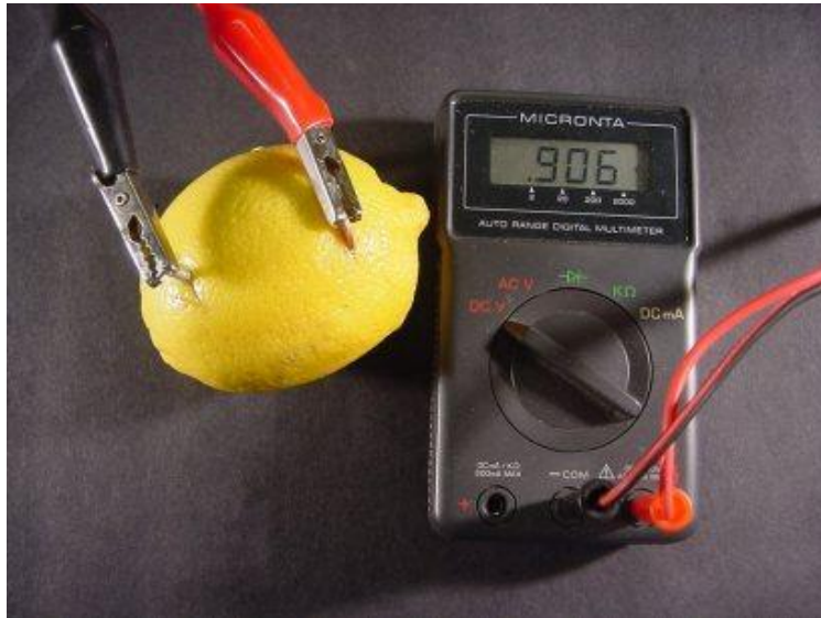
11. kísérlet: Citrom-galvánelem készítése és feszültségének mérése
